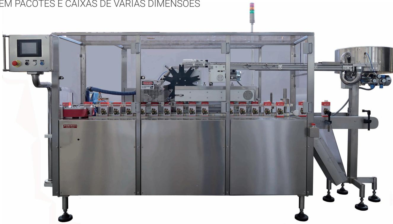
As tampas, deitadas a granel em uma tremonha, são orientadas e extraídas continuamente da máquina por meio de ventosas. Um sistema de colagem hot-melt permite aplicar uma camada uniforme de cola na tampa que é imediatamente aplicada com precisão e prensada no pacote até garantir uma colagem perfeita.
